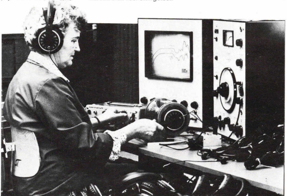
Afb. 6. Eindcontrole van hoofdtelefoons. Elke hoofdtelefoon en elke microfoon, van welke prijsklasse ook, worden stuk voor stuk getest.
